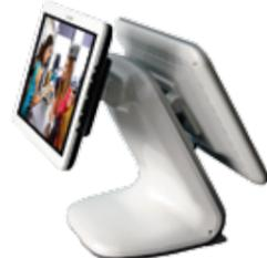
Axon POS serie 2500 può funzionare anche come soluzione Digital Signage, difatti il sistema può essere dotato di un monitor supplementare LCD da 12 pollici appositamente studiato per visualizzare filmati ad alta risoluzione, messaggi promozionali, comunicazioni personalizzate ed altro, indirizzati direttamente al cliente che transita alla cassa.
